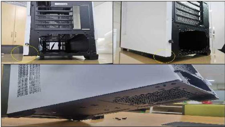
컴퓨터 케이스 파손 내역
